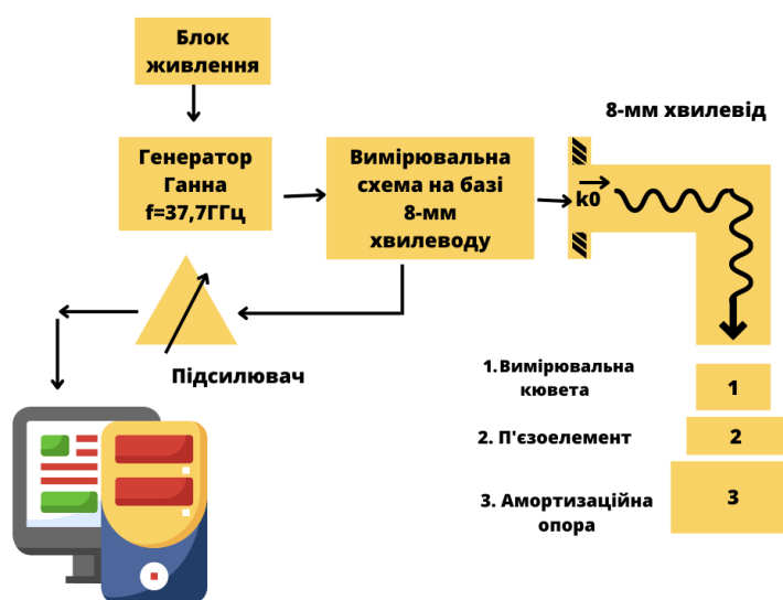
Рис. 1. Блок-схема апаратурно-реєструючого комплексу для вимірювання діелектричних параметрів та динамічного поверхневого натягу при модуляції п'єзоелемента акустичними частотами
