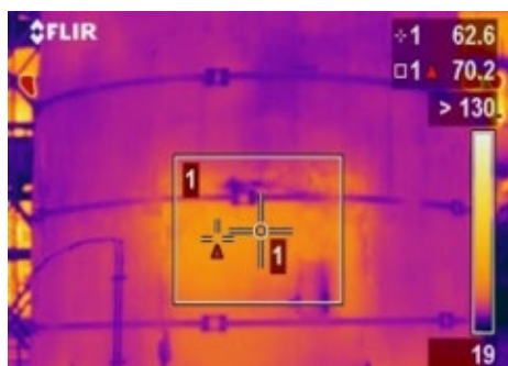
Рис. 3. Величезна температурна аномалія. Можлива причина – деградація обмурівки
